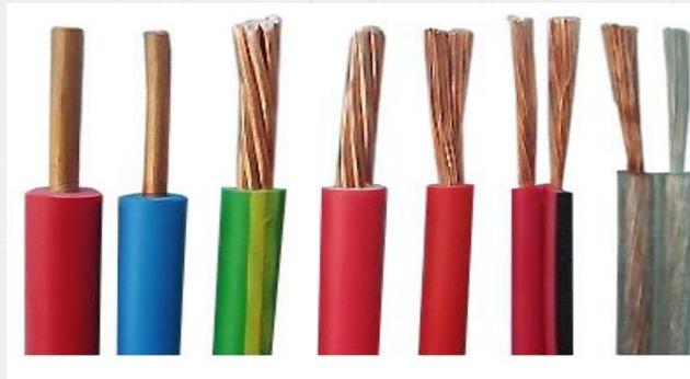
Esta norma desarrolla las especificaciones para la fabricación de los conductores con aislamiento termoplástico a base de cloruro de polivinilo (PVC) fabricados en los calibres 2,082 mm<sup>2</sup> hasta 507 mm<sup>2</sup> (14 a 4/0 AWG y 250 a 1 000 kcmil o MCM), utilizados en las instalaciones desde 50V hasta 600 V y a temperaturas de operación máximas en el conductor de 75 °C y 90 °C.
