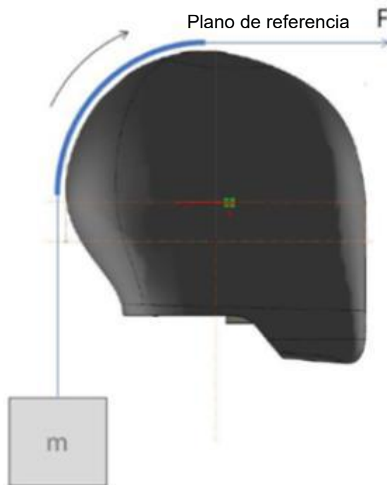
Figura E.1 - Ensayo para medir el coeficiente de fricción
